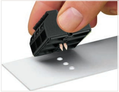
Montaj plakasına otomatik temas sağlar. Plakanın verniği üzerinden nüfuz eder.
