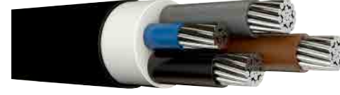
0,6/1 kV NA2XH, Tek veya Çok Damarlı Enerji Kablosu, Alüminyum İletkenli, XLPE izoleli, HFFR Kılıflı
