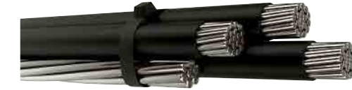
0,6/1 kV AER, Havai Alüminyum Örgülü İletken - PE kılıflı - Nötr çıplak
