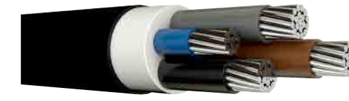
0,6/1 kV NAYY (YAVV) Tek veya Çok Damarlı Enerji Kablosu, Alüminyum İletkenli, PVC İzoleli, PVC Kılıflı
