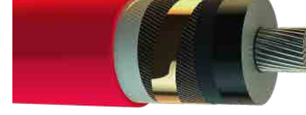
20,3/35 kV YAXC7V-R, XLPE Yalıtkanlı, Alüminyum İletkenli, Orta Gerilim Enerji Kabloları
